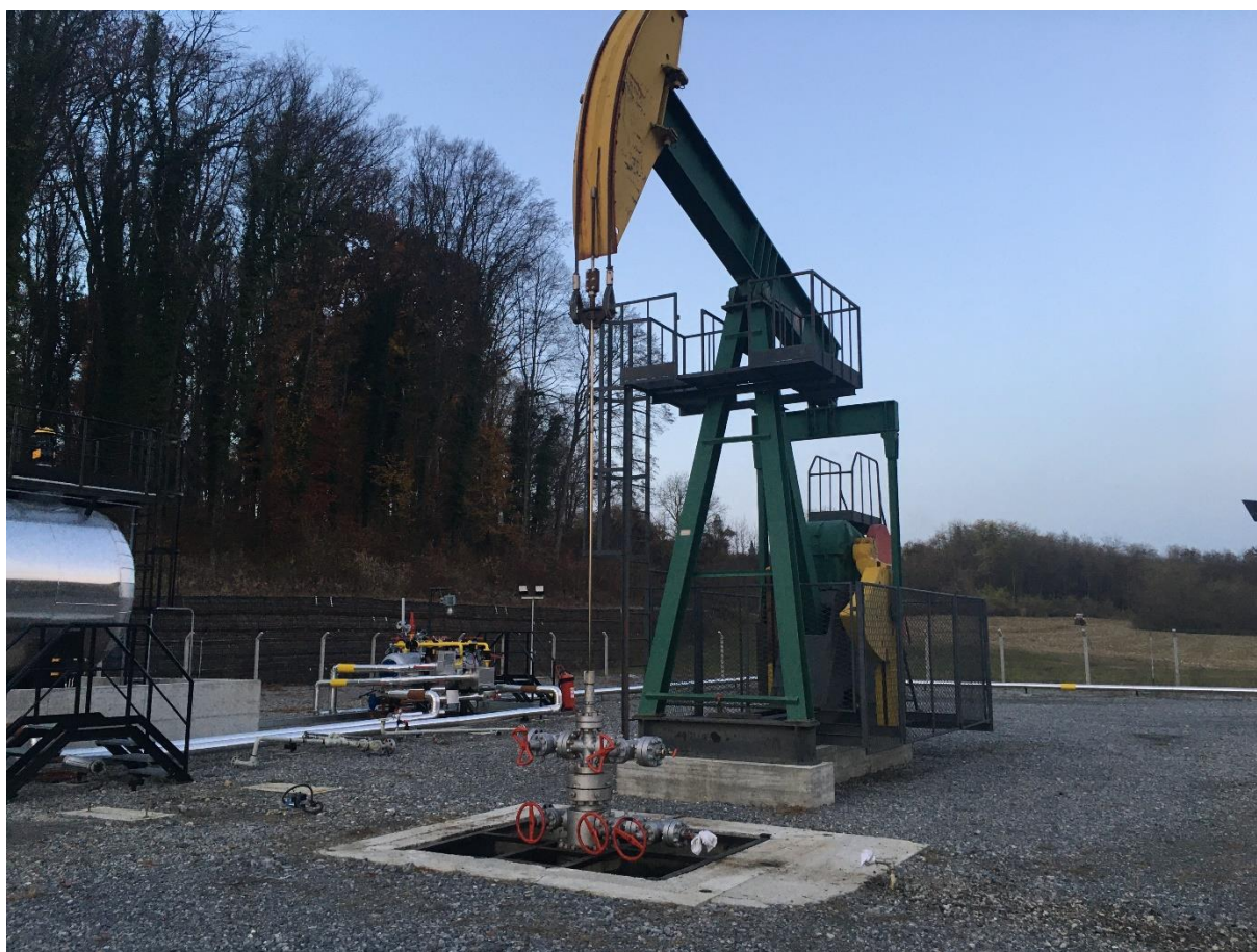
Grafički prikaz A-12: Primjer bušotine s njihalicom
