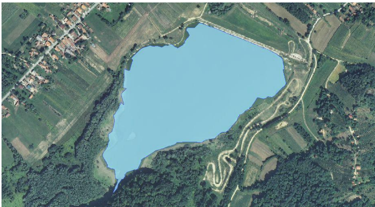
Sl. 1.2-4 Doseg vode za uobičajenu razinu vode u akumulaciji (H=158,0 m n. m.)
