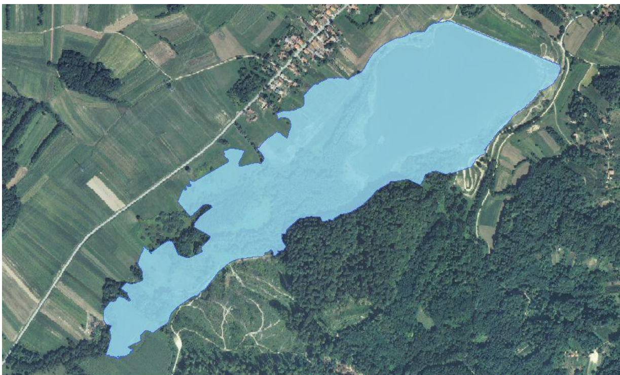
Sl. 1.2-6 Doseg vode za razinu vode identičnu postojeće kote krune ( H=161.3 m n. m.)
