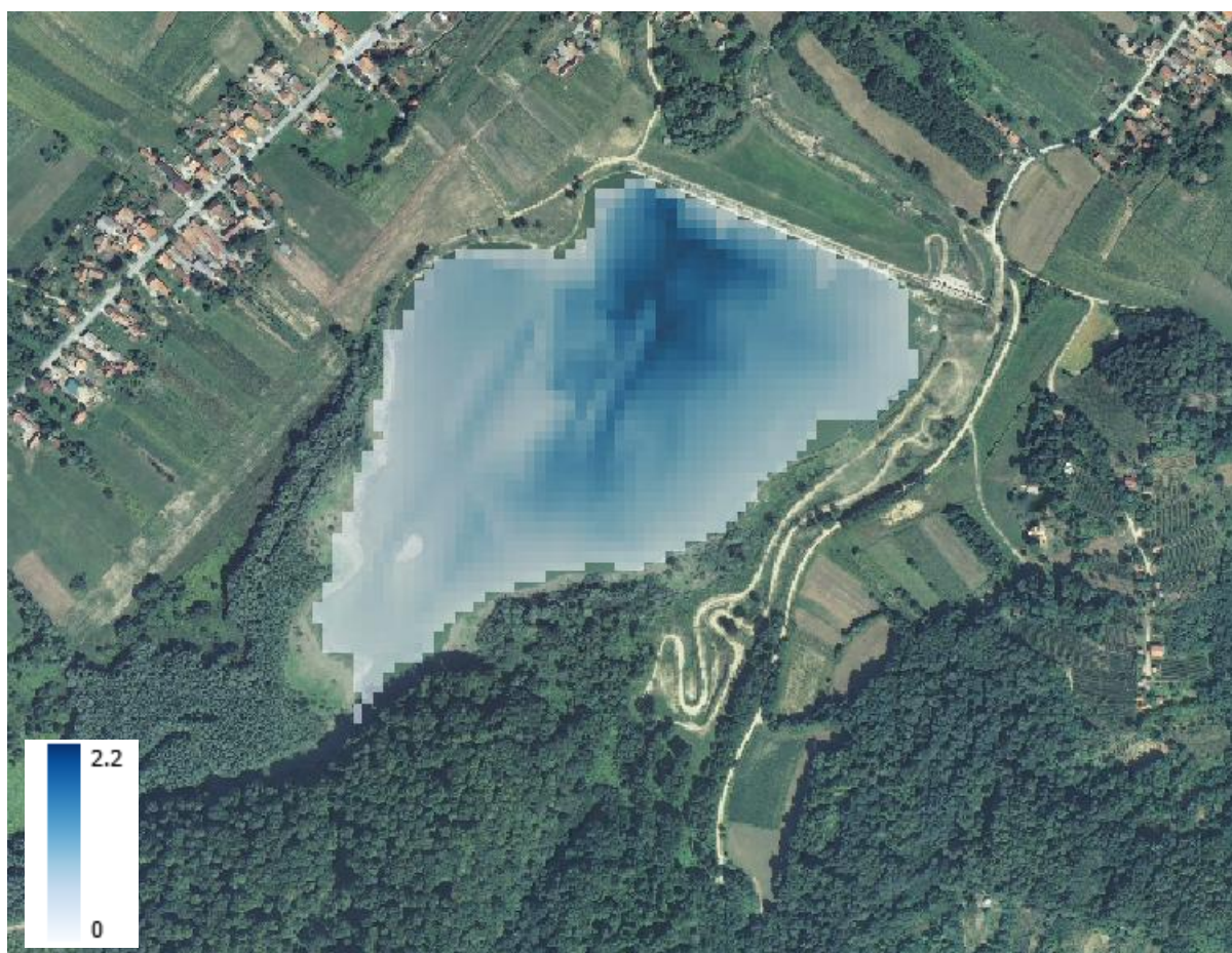
Sl. 1.2-1 Grafički prikaz – dubine vode akumulacije Rasinja u odnosu na stalnu razinu vode od 158.0 mm
