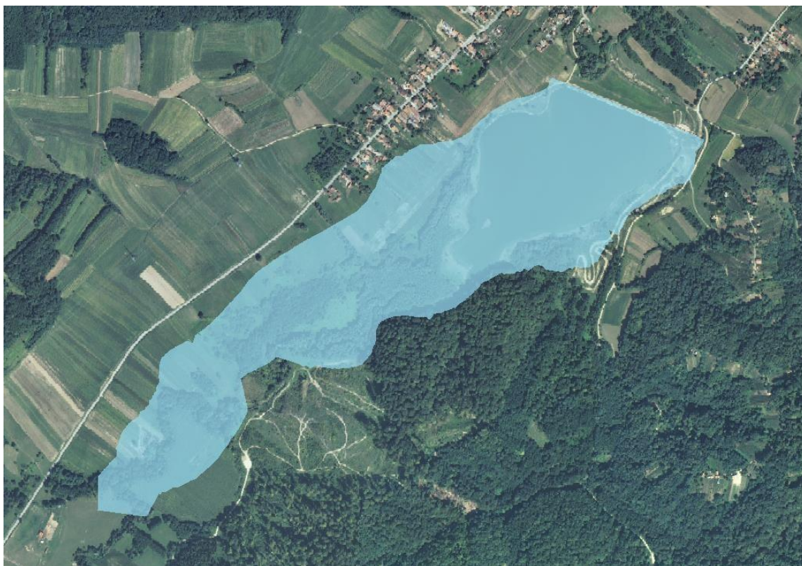
Sl. 2.2.1 Maksimalna razina vode u retenciji ( H=162,7 m n. m.) varijantnog rješenja 2
